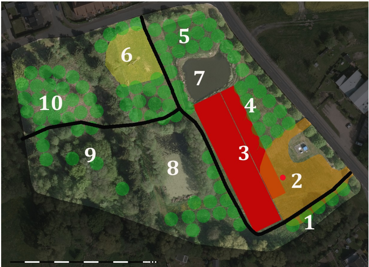
Zeichnung Nr. 2, Nutzungsbereiche: 1-Uferbereich Moehlenbäk, 2-befestigte Bewirtschaftungsfläche bei Veranstaltungen, 3-genormte Wettkampfbahnen für die Feuerwehr, 4 und 5-Reservefläche Hochzeitsbäume, 6-Kinderspielplatz, 7-Regenrückhaltebecken und Löschwasserentnahmestelle, 8-Biotop, verlandender Teich, 9 und 10-integrierte Privatfläche, Reservefläche Obstarche
